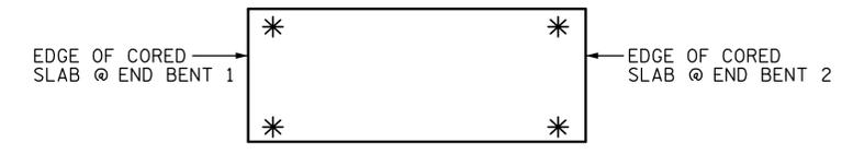
LOCATION OF ANCHORS FOR GUARDRAIL
