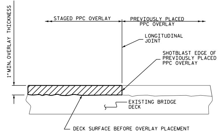
STAGED PPC OVERLAY JOINT
