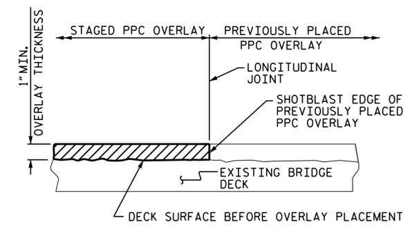
STAGED PPC OVERLAY JOINT (AS NEEDED)
