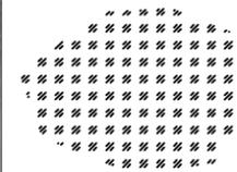
DENOTES ANTICIPATED UNDERCUTTING AREAS DUE TO PLASTIC SOILS. UNDERCUTTING NOT REQUIRED IF CHEMICAL STABILIZATION PERFORMED.
