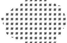
DENOTES ANTICIPATED UNDERCUTTING AREAS DUE TO PLASTIC SOILS. UNDERCUTTING NOT REQUIRED IF CHEMICAL STABILIZATION PERFORMED.
