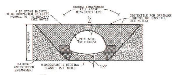
CRITICAL BACKFILL ZONE, PRESSURE ON SOIL GREATEST HERE.
