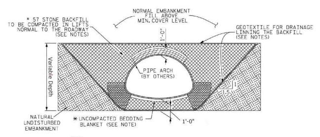
CRITICAL BACKFILL ZONE, PRESSURE ON SOIL GREATEST HERE.
