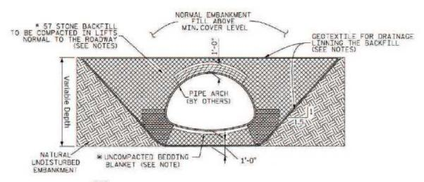
GRITICAL BACKFILL ZONE, PRESSURE ON SOIL GREATEST HERE.
