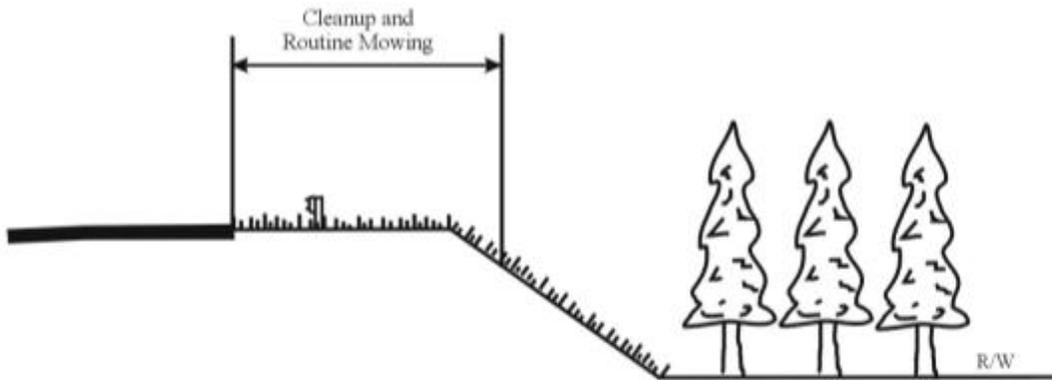
**TYPICAL FILL SECTION WITH ROOM BEHIND GUARDRAIL FOR MOWER.**
