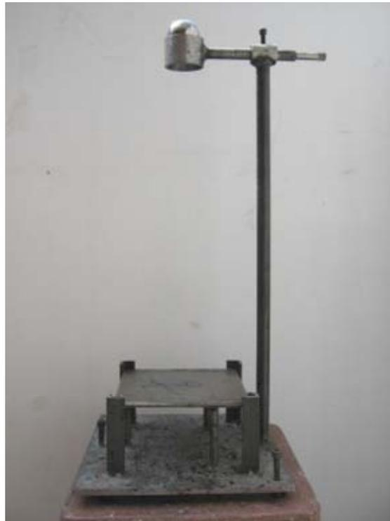
**Figure 3-4 Vialit test apparatus**
