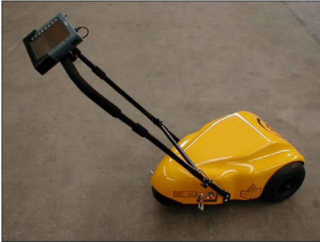
Figure 17 WDM, Ltd.'s Mini Texture Meter
