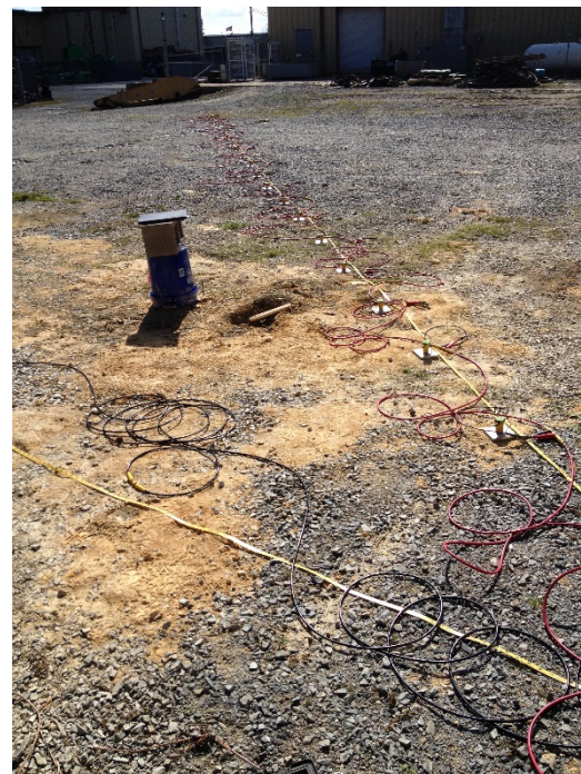
(d) Additional array for MASW
