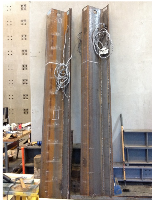
(d) Instrumented sheet piles
