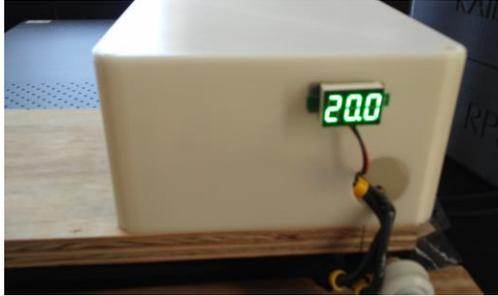
*Figure 3.23 LCD Display Voltmeter*
