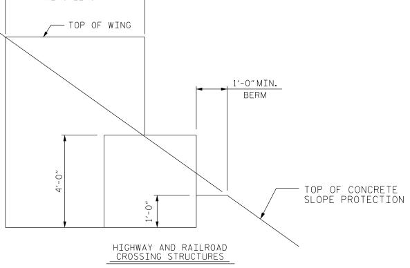
REQUIRED LENGTH OF THE WINGS (4'-0" DEEP END BENT CAPS)
