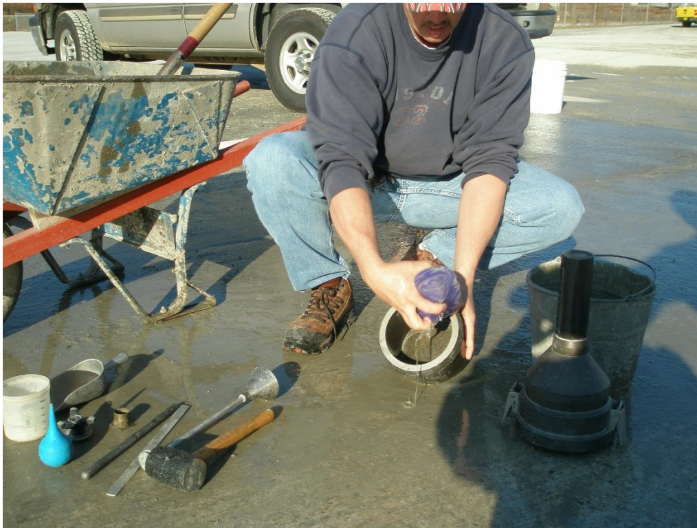
Dampen roll-o-meter bowl. Pour off excess water.
